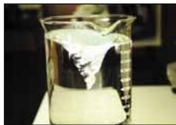
图 1 磁力搅拌过程形成涡旋
