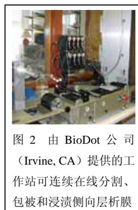
图2 由BioDot公司（Irvine, CA）提供的工作站可连续在线分割、包被和浸渍侧向层析膜
